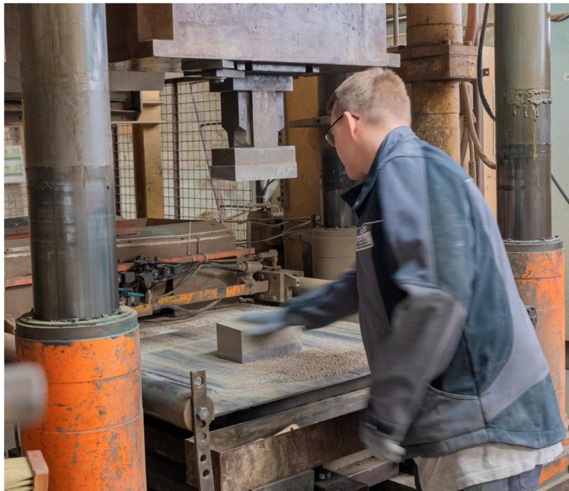
Steinproduktion an einer hydraulischen Presse.
